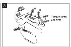
Mount the Acerbis tank on the motorcycle. Tighten the screw (G) again. Retighten the screws (B+C) of the saddle and spoilers. Montare il serbatoio Acerbis sulla moto. Riavvitare la vite (G). Riavvitare le viti (B+C)
